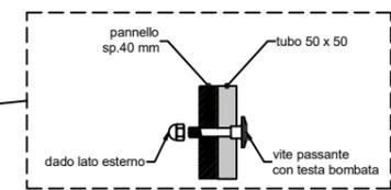
VISTA LATERALE FISSAGGIO TUBO A PANNELLO
