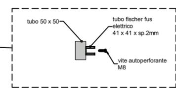
VISTA LATERALE FISSAGGIO FISCHER FUS ELETTRICO A TUBO
